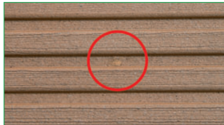
Natürlicher Fasereinschluss nach mechanischer Behandlung
