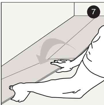
Drücken Sie stirnseitig die nächste Diele schräg in die erste und legen Sie diese auf den Boden. Dabei soll die Längsseite auf die Verriegelungsseite der vorhandenen Diele gelegt werden.
