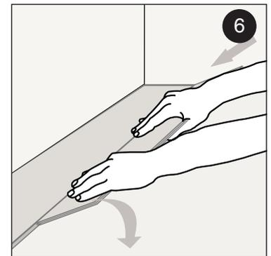
Drücken Sie die Längsseite der Diele im Winkel gegen die davor liegende Diele. Pressen Sie die Diele weiter nach vorne und legen Sie sie gleichzeitig an den Boden an.
