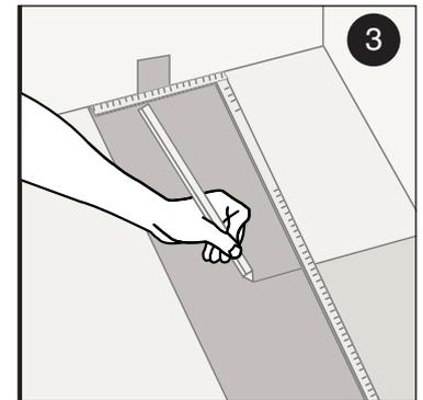
Legen Sie die letzte Diele mit der Unterseite nach oben, die Stirnseite ohne Verriegelungsleiste der Wand zugewandt. Der Abstand zur Wand soll ca. 10 mm betragen. Markieren Sie die Stelle, an der die Diele abgesägt werden soll.
