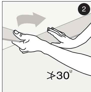
Drücken Sie die nächste Bodenele im Winkel an die erste Diele, und drücken Sie anschließend die Diele auf den Boden. Verfahren Sie in der gleichen Weise mit der gesamten ersten Reihe.
