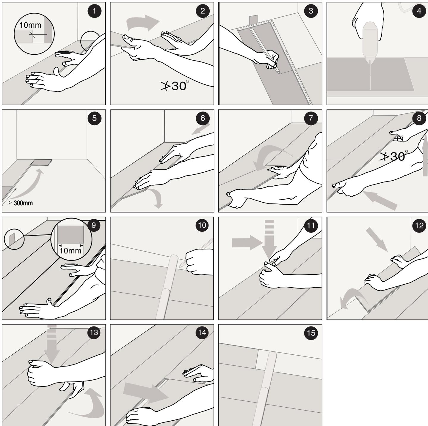
1. Legen Sie das erste Element entlang der Wand aus. Dabei werden die Federseiten gegen die Wand gelegt. Achten Sie darauf, dass Sie ca. 10 mm Abstand zwischen der Stirnseite der Diele und der Wand haben. Der Abstand der Längsseite von der Wand (ca. 10 mm) kann später festgelegt werden, wenn drei Reihen verlegt worden sind.
