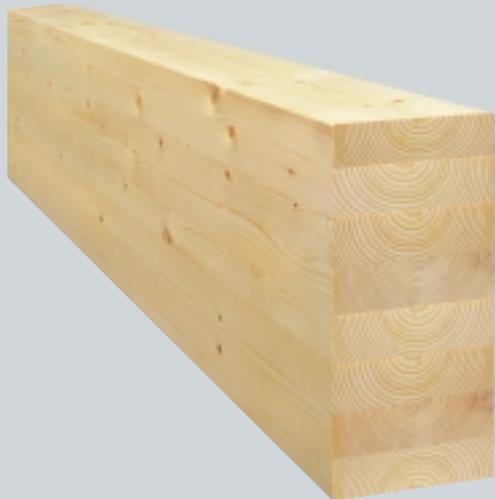
Der fertige Querschnitt zeigt die gleichsinnige Ausrichtung der Jahrringverläufe in den einzelnen Lamellen zur Reduzierung innerer Spannungen. Üblicherweise hat die sehr dünne Klebstofffuge eine helle Färbung oder ist transparent. Klebstoffe für besondere Einsatzbereiche können auch eine dunkelbraune Färbung haben.
