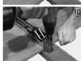
⑩ Den IGEL in gespanntem Zustand anschrauben (max. 4 Nm).
