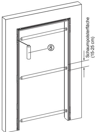
(8) Vergewissern Sie sich, dass die zu verschäumenden Stellen staub- und fettfrei sind. Bei Wandstärken unter 150 mm soll die Höhe Schaumpolster mindestens 25 cm betragen; bei Wandstärken über 150 mm mindestens 15 cm. Beachten Sie beim Befestigen der Zargen zusätzlich die Richtwerte der folgenden Tabelle:
