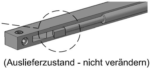
1. Automatischen Türeinzug mit den beiliegenden Schrauben auf der Halterung montieren. Achten Sie dabei auf die Wirkrichtung des Automatischen Türeinzugs (Montagebeispiel)
