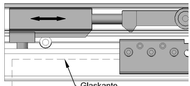
4. Endkappe auf der Einzugseite lösen, den **Aktivator in die Nut** einschieben und befestigen
