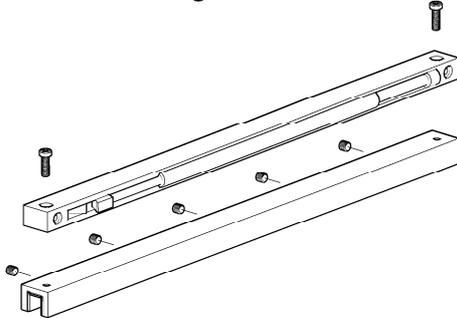
2. Automatischen Türeinzug direkt neben dem Klemmbeschlag platzieren und mit den Gewindestiften auf der Rückseite befestigen. Anschließend die Tür, wie unter Punkt 4 in der System-Montageanleitung beschrieben, montieren
