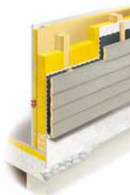
Wandaufbau der Holzskelettbauweise.
