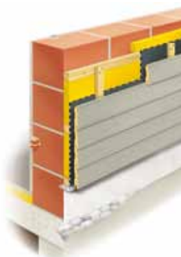
Wandaufbau der Massivbauweise.
