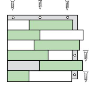
Benutzen Sie zur Anbringung der Platten Senkkopfschrauben. Diese drehen Sie nach Befestigung der 1. Platte jedoch noch nicht komplett fest.
