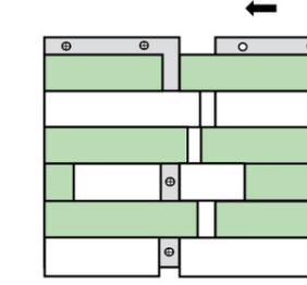
Die nächste Platte schieben Sie nun bis fast an die Schrauben der 1. Platte. Nach Festdrehen der Schrauben schieben Sie anschließend die Platten dicht zusammen.
