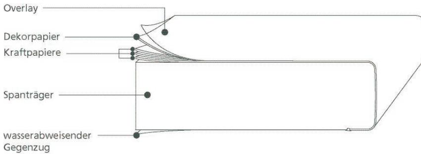
Qualitätsspanplattenträger Typ P2 oder P3 (quellarm) nach DIN EN 312, Oberseite und vordere Kante beleimt mit GetaLit (HPL), 0,7 mm, Vorderkante abgerundet – **Radius 4 mm**. Unterseite und rückseitige Kante mit wasserabweisendem Gegenzug beleimt, Stoßstelle GetaLit/Gegenzug feuchtebeständig versiegelt.
