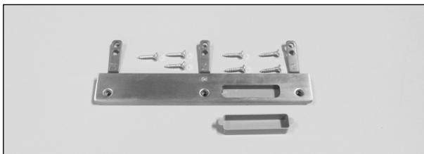
Das Austauschset Schließblech 190 ohne Riegelloch besteht aus dem Schließblech mit Schiebeunterfütterung und Stahllaschen, einem Riegeltopf für mit zweitouriges Abschließen und 7 SPAX-Schrauben 4 x 20.
