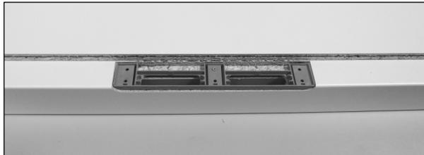
Kunststoffunterfütterung mit den Stahllaschen einsetzen.
