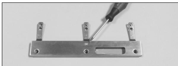
Die Kunststoffunterfütterung vom Schließblechwinkel abschrauben.
