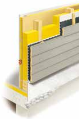
Wandaufbau der Holzskelettbauweise.
