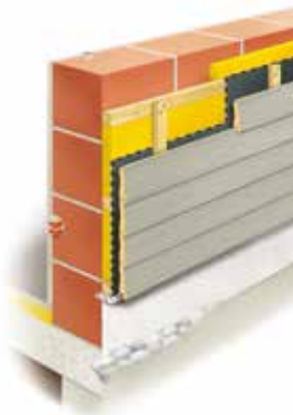
Wandaufbau der Massivbauweise.
