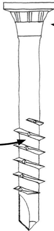
Die spezielle, selbstschneidende Gewindeform ermöglicht einen perfekten Halt, ohne die Metallprofile vorzubohren.
