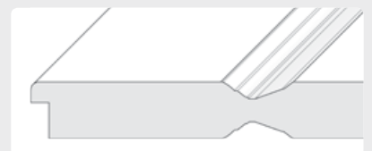
Türblatt mit liegenden Hohlprofilen, Einlage aus Röhrenspanplatten
