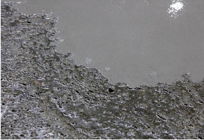
Abb. 6 – Verlaufende Spachtelmasse im Detail.
