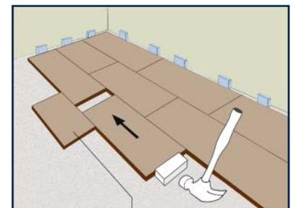
Beide Verbindungssysteme sind an der Längsseite kompatibel und miteinander verlegbar. Eine Paneelreihe darf nur aus einem System (herkömmliches oder *Express Clic*) bestehen.
