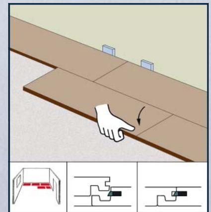
Panel abwinkeln – Querverriegelung rastet bei leichtem Druck hörbar ein
