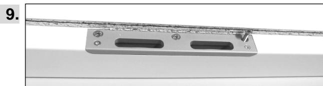
Das Schließblech auflegen, ausrichten, dicht an die Fräskanten drücken und zunächst mit den Schrauben 3,5 x 25 in der Bekleidung festschrauben. Danach das Schließblech mit den Schrauben M 5 x 20 mit der rückseitigen Halteplatte verschrauben und die Dichtung wieder einziehen
