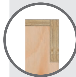
Ausgelenkter Wandständer mit durchgehendem Fenstersturz und Rähm
