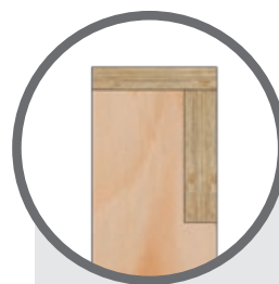
Ausgelenkter Wandständer mit durchgehendem Rähm
