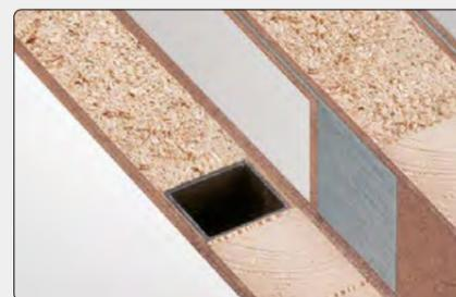
Klimaklasse III mit Stahlrohrverstärkung oder Aluminiumverbundabsperung
