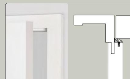
Bei der stumpfen Ausführung bildet das Türblatt eine annähernd bündige Ebene mit der Bekleidung.
