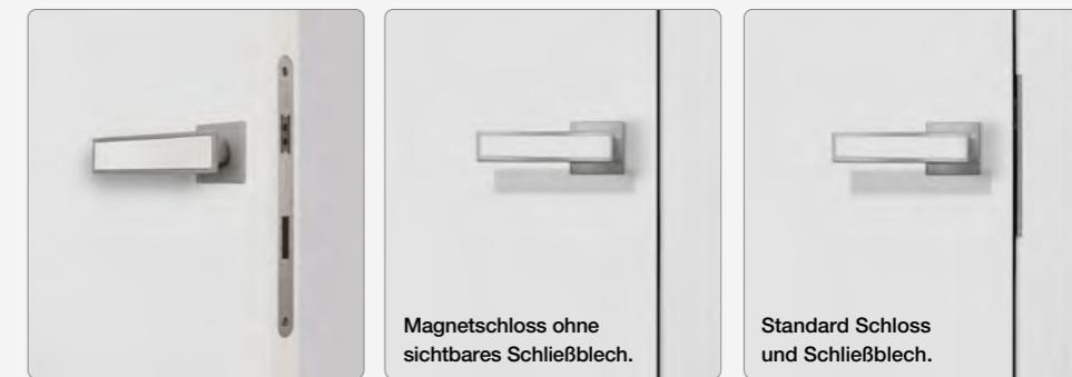
Beim Magnetschloss ist das Schließblech bei geschlossener Tür nicht sichtbar, da die Falle erst bei vollständig geschlossener Tür magnetisch verriegelt, ohne dass ein mechanischer Kontakt zum Schließblech nötig ist. Dadurch reduziert sich auch das Schließgeräusch deutlich.
