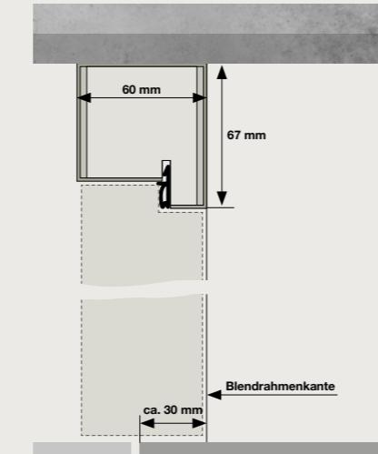
Die Ausführung „auf der Wand“ kommt immer dann zum Einsatz, wenn zum Beispiel eine vorhandene, schmale Maueröffnung mit einer Tür versehen werden soll. Der Blendrahmen wird dann auf die Wand aufgesetzt und verringert nicht das Durchgangsmaß.
