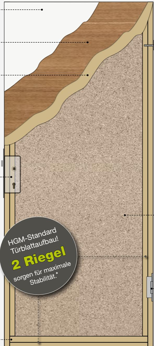
\* 2. Riegel = MDF / Fichte / Span-Verstärkungsstreifen zur Stabilisierung im Schloss und Bandbereich.
