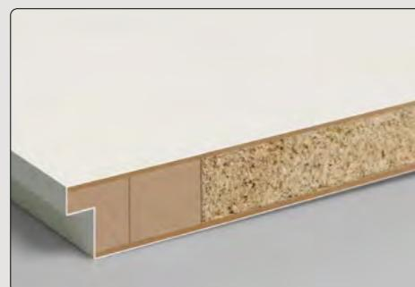
**Röhrenspan-Mittellage:** Die Standard-Mittellage bei HGM Türen. Die Röhrenspan-Mittellage sorgt für hohe Stabilität und gute Schallschutzwerte bei moderatem Türblattgewicht.
