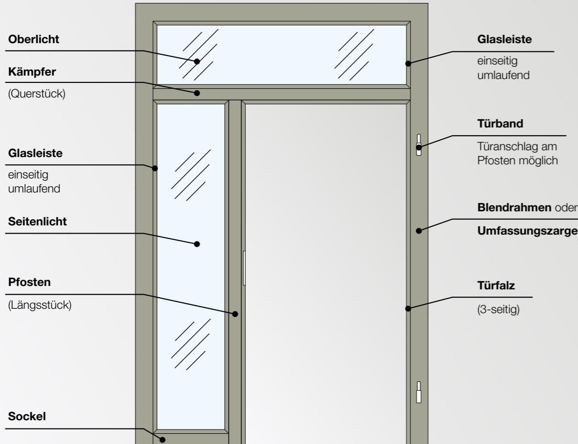
**Querschnitt** – Windfangelement mit Verglasungen **Umfassungszarge**
