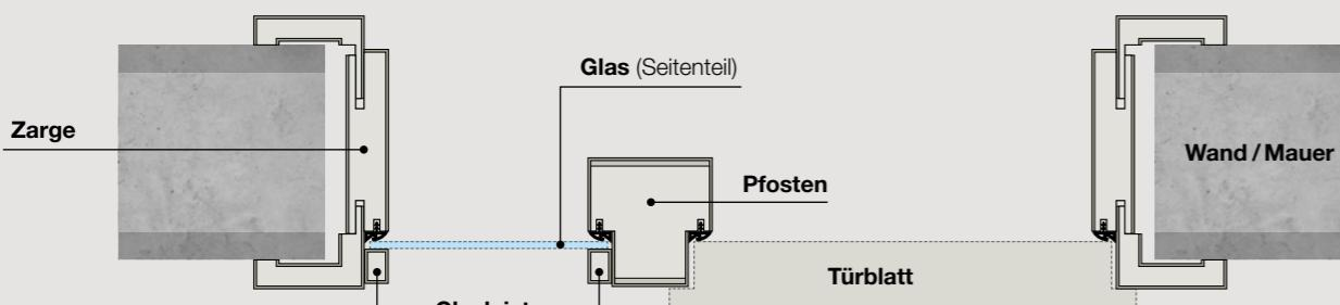
**Querschnitt** – Windfangelement mit Verglasungen **Blendrahmen**
