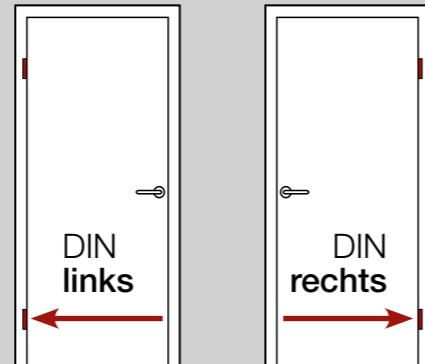
Die DIN Richtung gibt an, in welche Richtung die Tür geöffnet wird. Sie wird von der Türseite aus ermittelt, an welcher sich die Bänder befinden.
