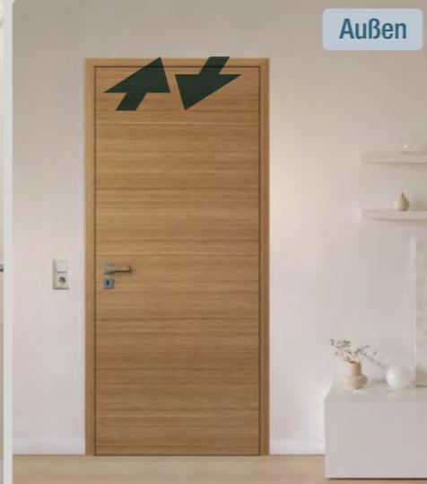
Ebenso wirkt die vergrößerte Bodenluft optisch eher unschön und funktioniert nur bei glatten Böden gut. Durch die vergrößerte Bodenluft erhöht sich aber vor allem das Verletzungsrisiko – zum Beispiel durch Einklemmen der Zehen. Besonders bei Kleinkindern, kann das passieren und zu erheblichen Verletzungen führen.
