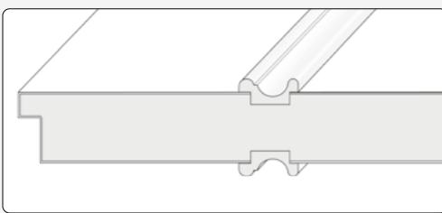
Türblatt mit eingefrästen und eingesetzten Leisten.
