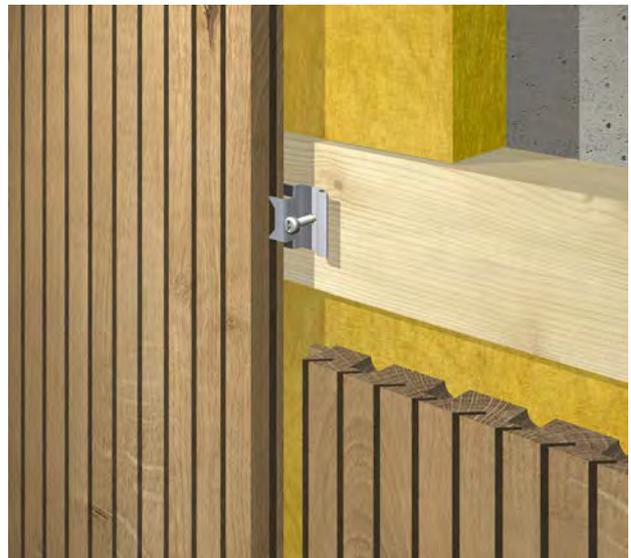
Detail vertikale Montage mit Montageclip
