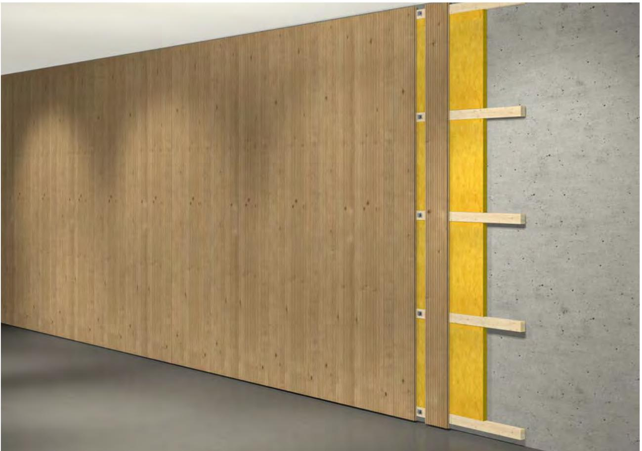
Vertikale Montage ohne Fugenversatz
