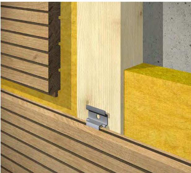
Detail horizontale Montage mit Montageclip
