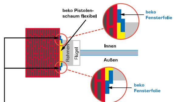
Bei ein- und wechselseitig (e/w) klebenden Fensterfolien muss am Mauerwerk mit **Gecko Hybrid POP** verklebt werden. Die ein- und wechselseitig + vollflächig klebende Folie kann direkt auf das Mauerwerk aufgeklebt werden.
