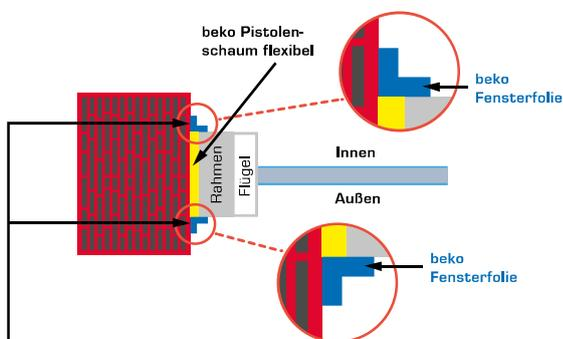
Bei ein- und wechselseitig (e/w) klebenden Fensterfolien muss am Mauerwerk mit **Gecko Hybrid POP** verklebt werden. Die ein- und wechselseitig + vollflächig klebende Folie kann direkt auf das Mauerwerk aufgeklebt werden.
