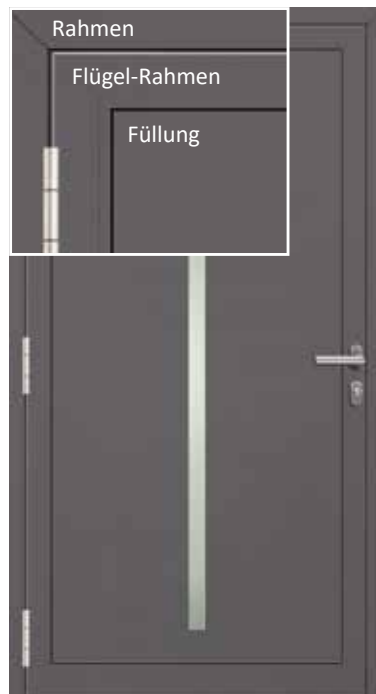
Innenansicht herkömmliche Tür nicht flügelüberdeckend
