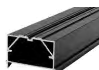
BIG-Isostep (Alu) 54 Terrassenlager Abstand Auflagepunkte max. 110 cm
