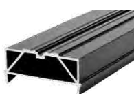
BIG-Isostep (Alu) 54 Terrassenlager Abstand Auflagepunkte max. 110 cm
