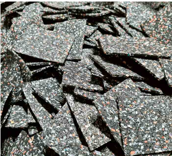
Isopads aus 95 % Altreifengranulat
