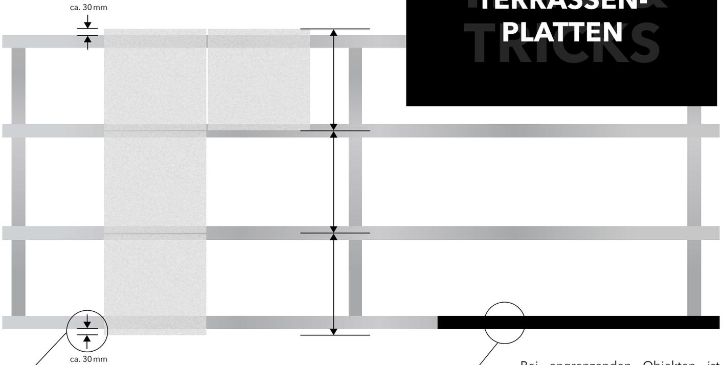
Die äußeren Plattenreihen sollten ca. 30 mm überstehen, damit die RELO RA Rand-Abschlussprofile angebracht werden können.
