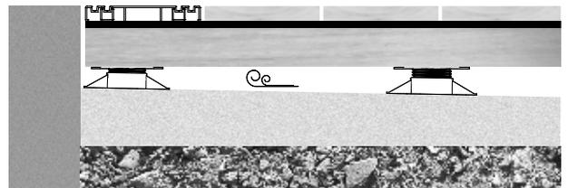
Bei weiterführenden Terrassen oder Umrandungen aus Stein, Beton oder Keramik (auf dem Höhengniveau des Deckbelags) sind Ventilationsprofile einzusetzen, damit eine optimale Belüftung gewährleistet ist. Sollte dies nicht möglich sein, ist ein Abstand von mind. 20mm erforderlich.
