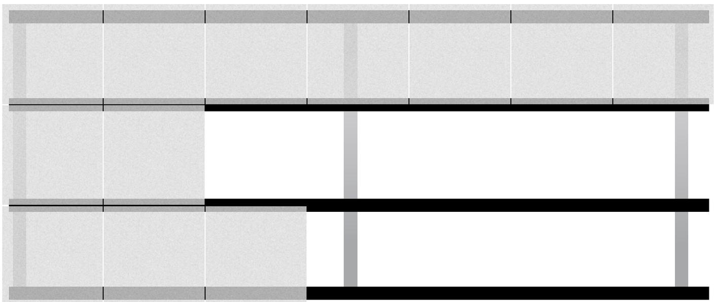
Die Terrassenplatten werden mit Hilfe von handelsüblichen Fugenkreuzen auf das gewünschte Fugenbild verlegt. Die Fugenkreuze können je nach Anschlusspunkt geteilt oder geviertelt werden.
