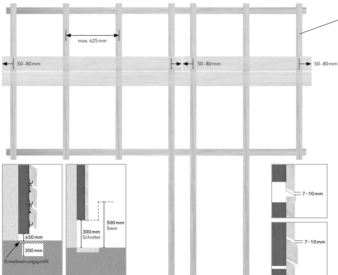
Befestigungsabstände für die Fassadenverkleidung an der Traglattung
