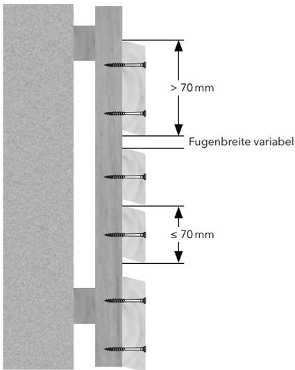
Rhombusleisten können mit verschiedenen Fugenbreiten, von Blickdichter bis offener Gestaltung, ausgeführt werden.
