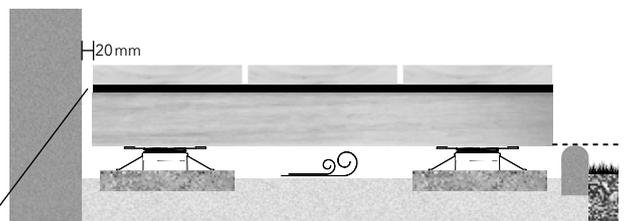
Begrenzungen müssen eine Belüftung der gesamten Konstruktion ermöglichen. Ein Abstand von mind. 20mm ist erforderlich. Die Terrassen-Unterkonstruktion ist im Optimalfall oberhalb angrenzender Terrassen-umrandungen einzubauen.
