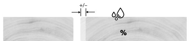
Die Holzfeuchte % ist vor der Verlegung der Dielen zu prüfen. Die richtige Ausgangsfeuchte des Deckbelages sorgt für eine störungsfreie und dauerhaft funktionierende Terrasse. Die optimale Holzfeuchte ist mit dem Holzlieferanten abzustimmen.
