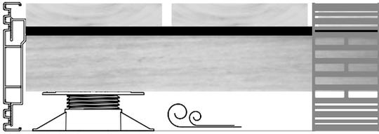
Seitlich umlaufende Verblendungen sind so auszuführen, dass eine Belüftung der gesamten Konstruktion gewährleistet ist z.B. mit dem Ventilationsprofil RELO V. Geschlossene Verblendungen mit Abdeckbretter verhindern eine Belüftung und rufen Störungen hervor.
