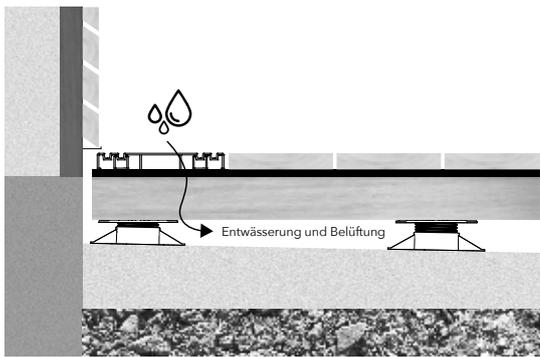
Entlang angrenzender Objekte wie z.B. an einer Fassade oder bei Schiebe- und Drehtüren etc. sollte das RELO V Entwässerungs- und Ventilationsprofil für eine optimale Belüftung, Entwässerung und Reduzierung von Verschmutzungen durch Spritzwasser, eingesetzt werden.
