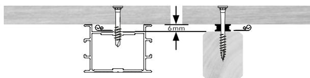
Eine Abstandsmontage (Belüftungsebene) von mind. 6mm sorgt für einen konstruktiven Schutz, reduziert das Quell- und Schwindverhalten der Dielen und Abschereffekte, die auf das Befestigungsmittel einwirken - direkte Kontaktflächen Holz auf Holz sind zu vermeiden.
