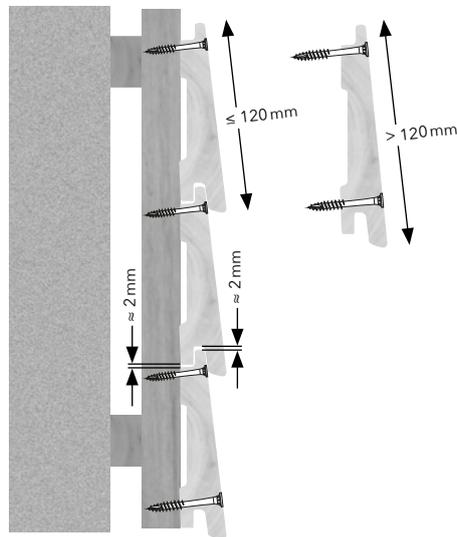
Profilbrettschalungen mit einer Nut-Feder Verbindung benötigen 2 mm Abstand zwischen Nutgrund und Feder, um Quellvorgänge ausgleichen zu können.
