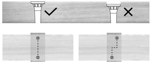
Die Schrauben sollten kopfbündig versenkt werden. Zu tief versenkte Schraubenköpfe fördern die Ansammlung von Schmutz und Wasser - dies kann zu Verfärbungen im Bereich des Schraubenkopfes führen. Die Anordnung der Schrauben kann in einer Linie oder versetzt erfolgen.
