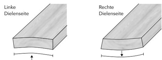
Für die rechte oder linke Dielenseite nach oben verbaut sprechen verschiedene Argumente. Je nach Produktionsprozess, Holzart und Profilierung sollte bei der Verlegung darauf geachtet werden, dass immer die gleiche Dielenseite verlegt wird.
