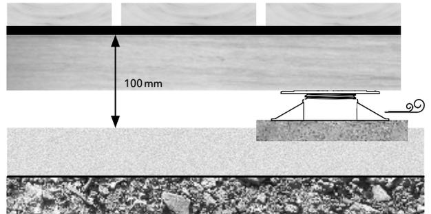
Eine Aufbauhöhe ab 100mm gewährt eine optimale Belüftung der gesamten Konstruktion. Mangelhaft belüftete Terrassen können Störungen wie z.B. Schüssellungen der Dielen und ein punktuelles Versagen der Befestigungsmittel hervorrufen.
