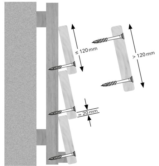
Stülpschalungen benötigen eine Überdeckung von ca. 20 mm. Die Einschraubtiefe in die Unterkonstruktion sollte mind. 26 mm betragen.
