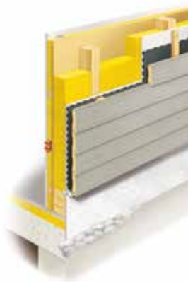
Wandaufbau der Holzskelettbauweise.
