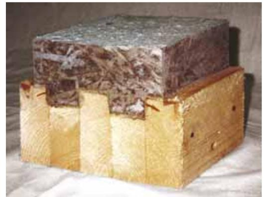
Die Holz-Beton-Verbundbauweise bietet auch im Altbau Vorteile. Sie stellt in Kombination mit stabförmigen Holzbauteilen bestehender Decken eine geeignete Maßnahme zur konstruktiven wie auch bauphysikalischen Ertüchtigung dar. Darüber hinaus finden Holz-Beton-Verbundkonstruktionen auch im Brückenbau Verwendung.
