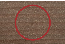
natürlicher Fasereinschluss nach mechanischer Behandlung
