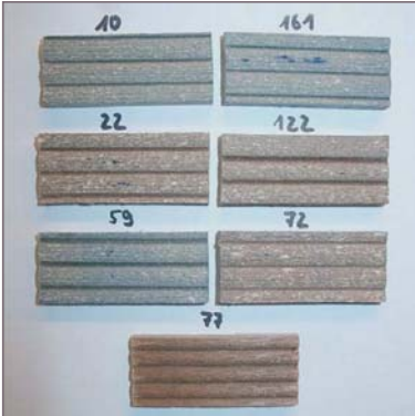
Abb. 3: Ausgewählte Prüfkörper nach der Schimmelpilzprüfung: makroskopisch kein Bewuchs erkennbar
